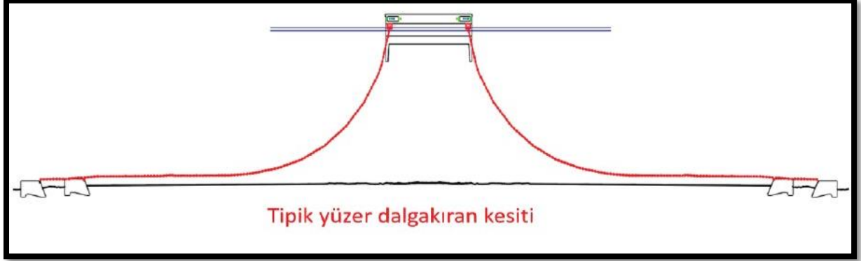
Şekil 43: Tipik Yüzer Dalgakıran Kesiti
