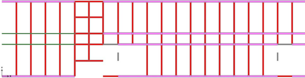
Şekil 6.30: Bina C 1. Kat Kiriş Yerleşim Planı
