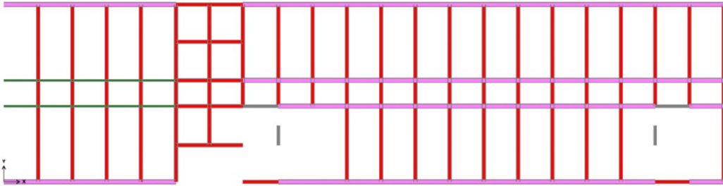
Şekil 4.36: Bina C 1. Kat Kiriş Yerleşim Planı
