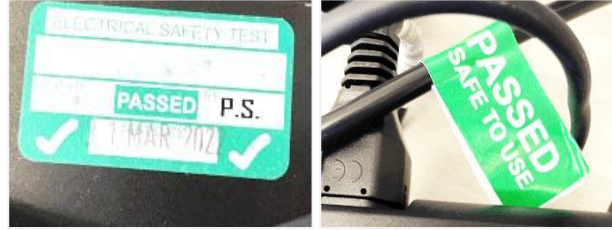
Şekil 7 Pat Test Etiketleri Örnek Görsel
