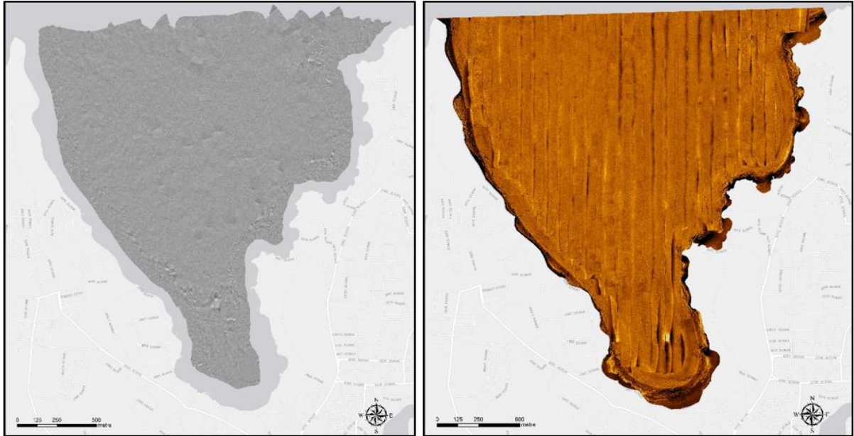
Şekil 3.59. Alibostan Koyu'nun multibeam (solda) iskandil ve yandan taramalı sonar (sağda) görüntülerinin birleştirilmesiyle oluşturulmuş mozaik haritaları
