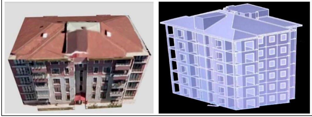
Şekil 3.4 Bir Binanın Fotogrametrik (Sol) ve Mimari (Sağ) 3B Modelinin Gösterimi [73]
