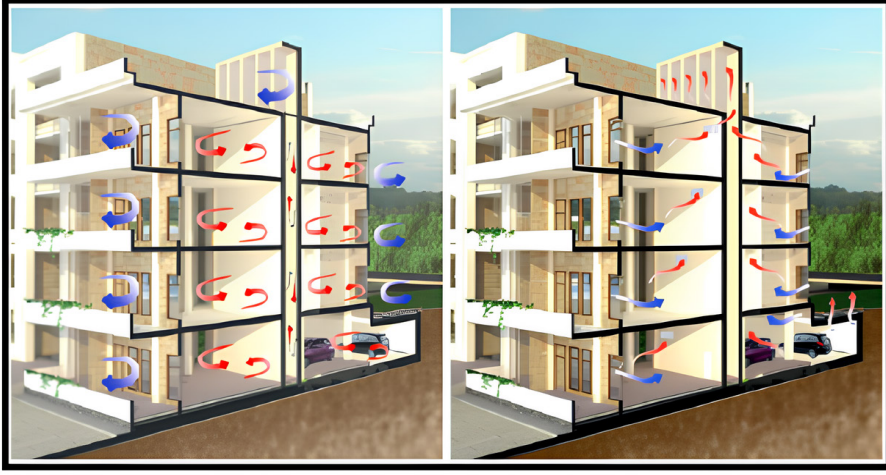
Şekil 6: Pasif ısıtma ve pasif soğutma prensipleri için toplu konutlarda özel baca sistemi.
