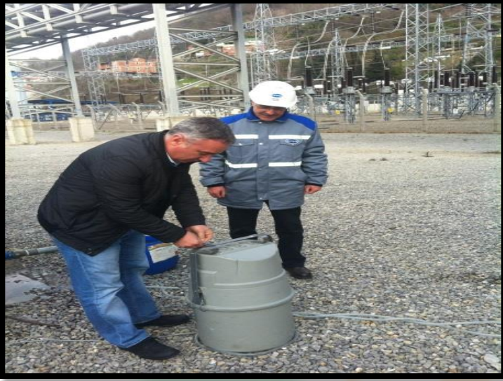
Eren Enerjiye Ait Atıksu arıtma Tesisinden kompozit numune alma cihazı ile alınan atıksu numuneleri
