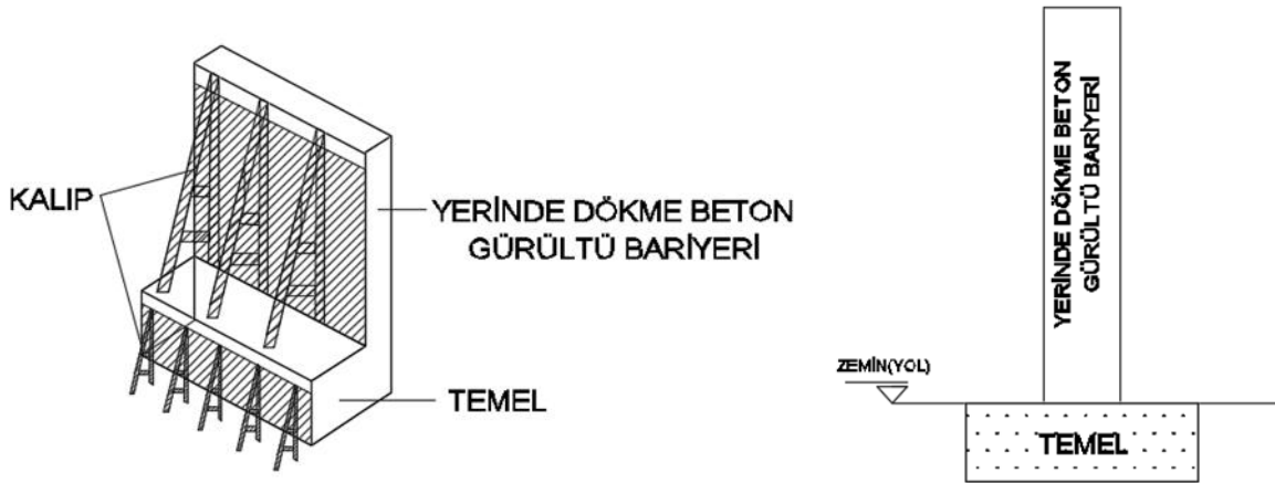
Şekil 19.10-1 Yerinde Dökme Beton Gürültü Bariyeri
