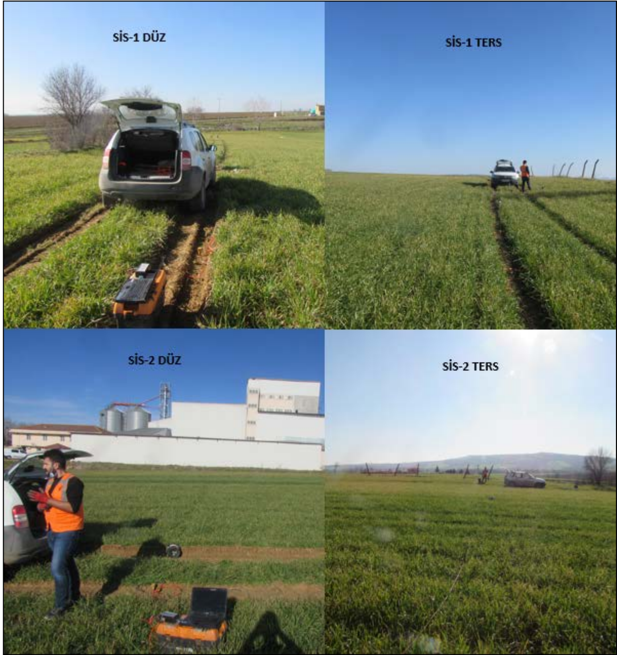
Şekil-13 : Etüt Alanında Yapılan Sismik Masw+kırılma Çalışmalarından Görünümler
