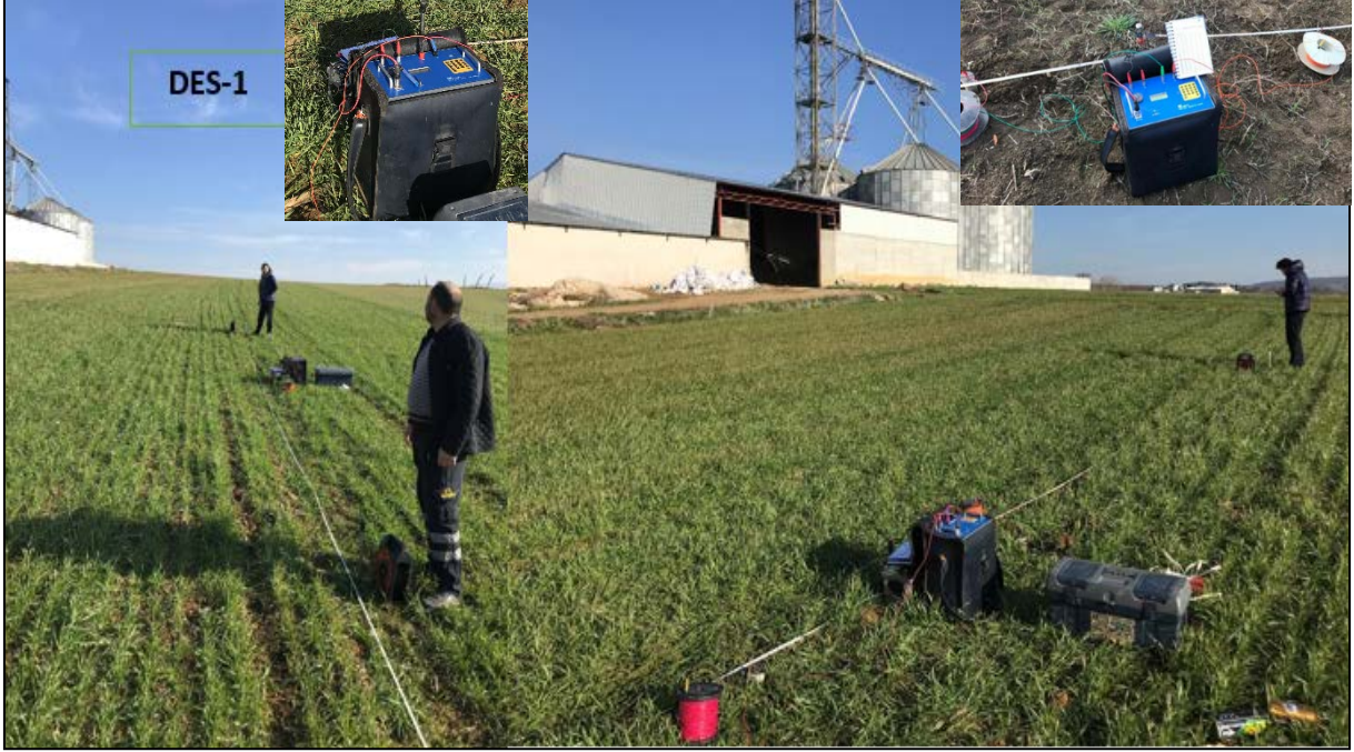
Şekil-14 : Jeofizik-Düşey Elektrik Sondaj Çalışmalarından Görünümler
