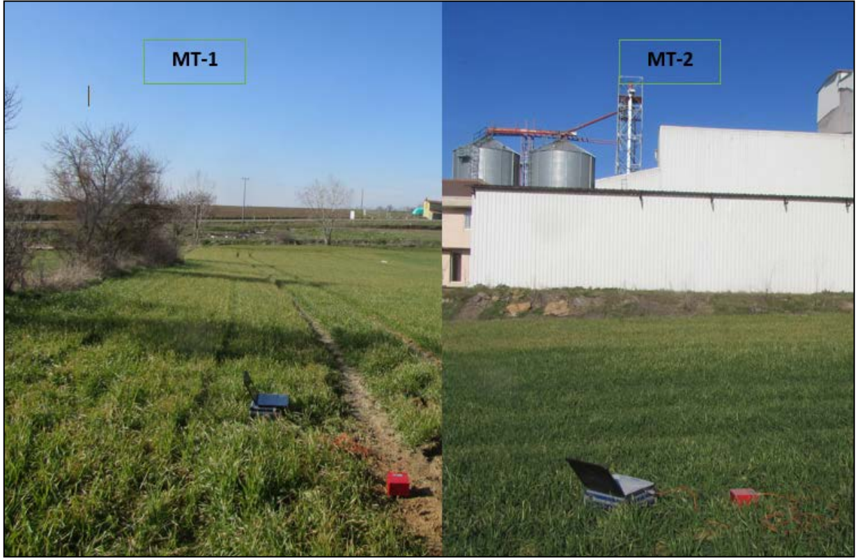
Şekil-15 : Arazide Yapılan Mikrotremör(MT-1,MT-2) Ölçümlerinden Görünümler
