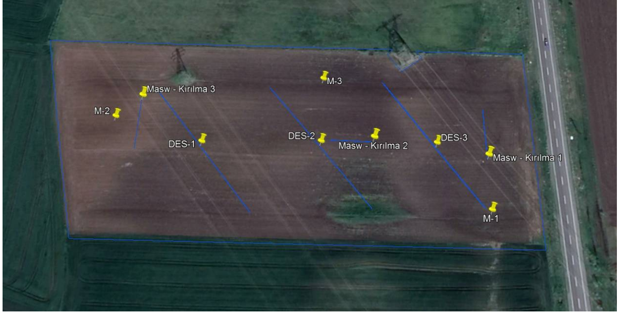
Şekil 11 Sondaj, MASW- Kırılma, DES, Mikrotremör Noktaları Vaziyet Planı
