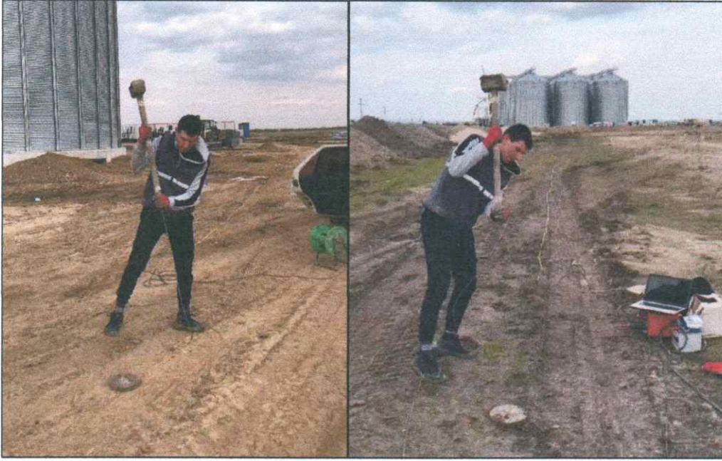
Şekil 13. Sismik çalışmalarına ait fotoğraflar.
