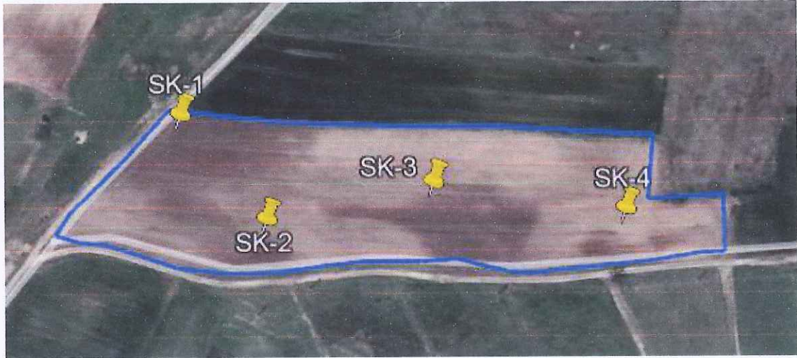
Şekil 6.1 İnceleme alanında açılan sondaj kuyuları
