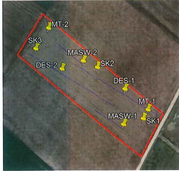
Şekil 6.1 İnceleme alanında açılan sondaj kuyuları
