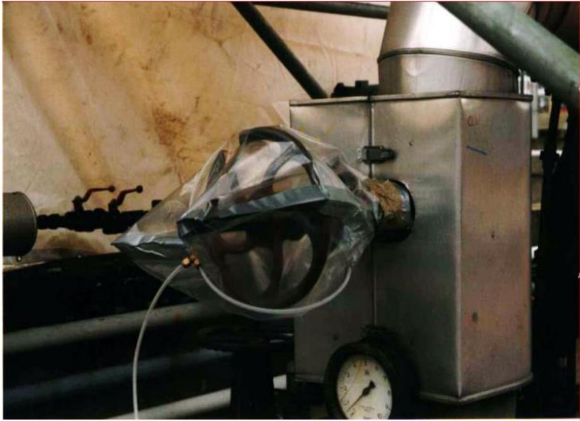
Şekil 3.58: Sızdıran bir vananın torbalanması
