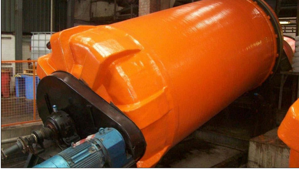
Şekil 2.2: Karıştırıcı veya eğimli işleyici
