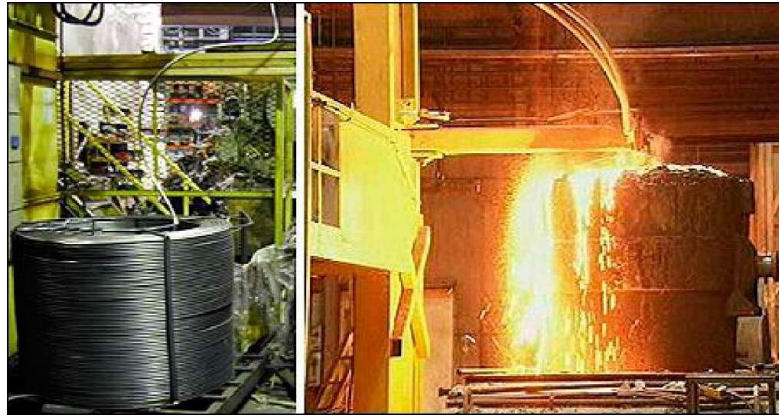
Şekil 2.22: Alüminyum tel kullanılarak gerçekleştirilen deoksidasyon [237, HUT, 2003]
