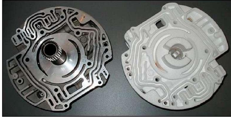
Şekil 2.37: Kayıp Köpük Prosesi İçin Genleşen Polistiren Modeli (sağda) ve Yitik Kalıp Metodu ile Üretilen Bir Döküm Örneği (solda) [237, HUT, 2003]
