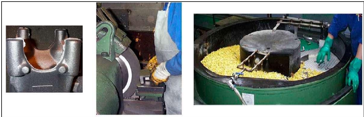
Şekil 2.51: Çapak (solda) ve Bileme Taşı (ortada) ve Sürgü Taşlama İşlemi (sağda) Kullanarak Çapağın Kaldırılması [237, HUT, 2003]
