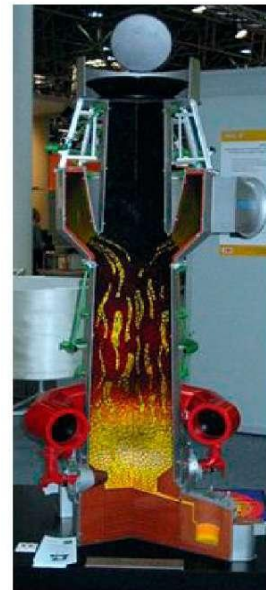
Şekil 2.9: Soğuk hava kupol fırınının şematik taslağı ve minyatür modeli [44, ETSU, 1993], [237, HUT, 2003]
