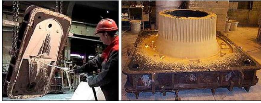
Şekil 2.34: Alkol bazlı kaplamalarda akıtmalı kaplama ve akabinde ateşleme ve kurutma [237, HUT, 2003]
