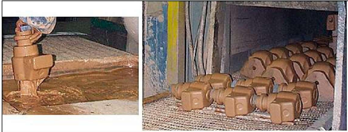
Şekil 2.35: Su Bazlı Kaplama Malzemeleri İle Daldırılmalı Kaplama ve Akabinde Sıcak Hava Fırınında Kurutma İşlemi [237, HUT, 2003]
