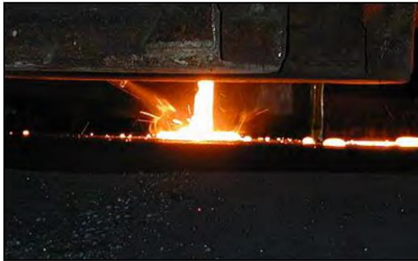
Şekil 2.24: Dökme sırasında aşılama [237, HUT, 2003]
