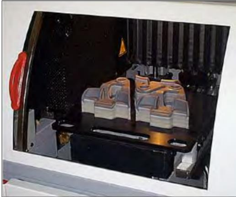
Şekil 2.6: Hızlı prototiplendirme makinesinde termopolimer (bal mumu) kalıp [237, HUT, 2003]
