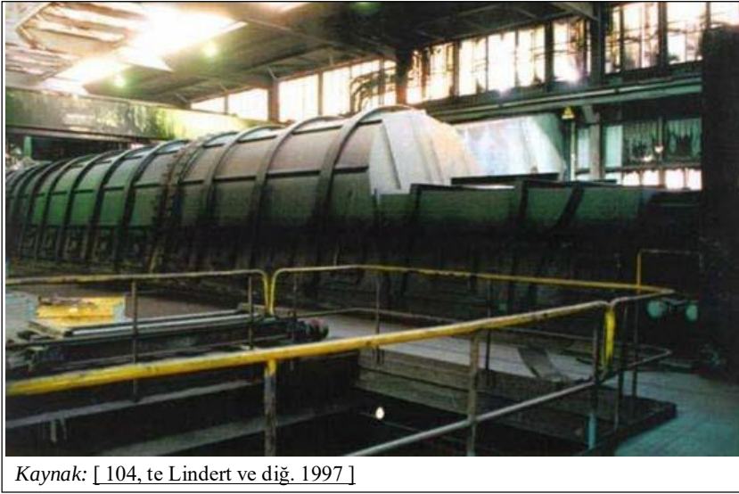
Şekil 3.21: EOS prosesine uygun kaplı sinter bandı
