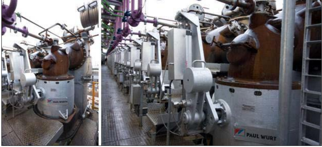
Şekil 11.5: Presli yükleme yapılan bir batarya üzerindeki SOPRECO Model 2 valfleri
