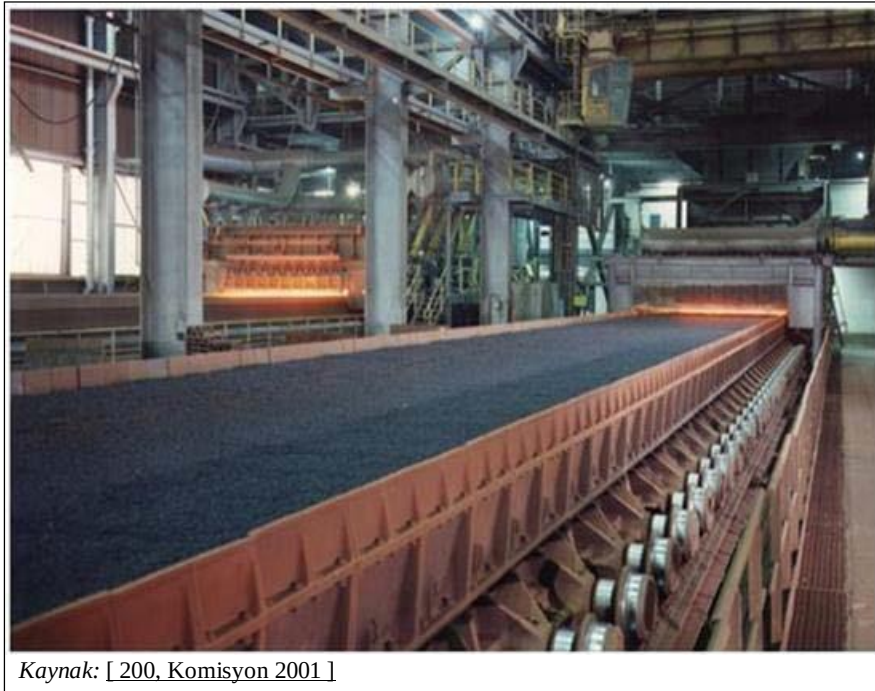
Şekil 3.1: Yükleme tesisi (tamburlar veya oluklar) ve başlangıç ucunda ateşleme kanopisi ile birlikte bir sinter bandının fotoğrafı
