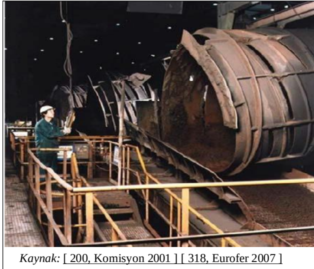
Şekil 4.1: Yeşil peletlerin oluşturulduğu bir peletleme tesisinin parçası olarak topaklaştırma tamburu
