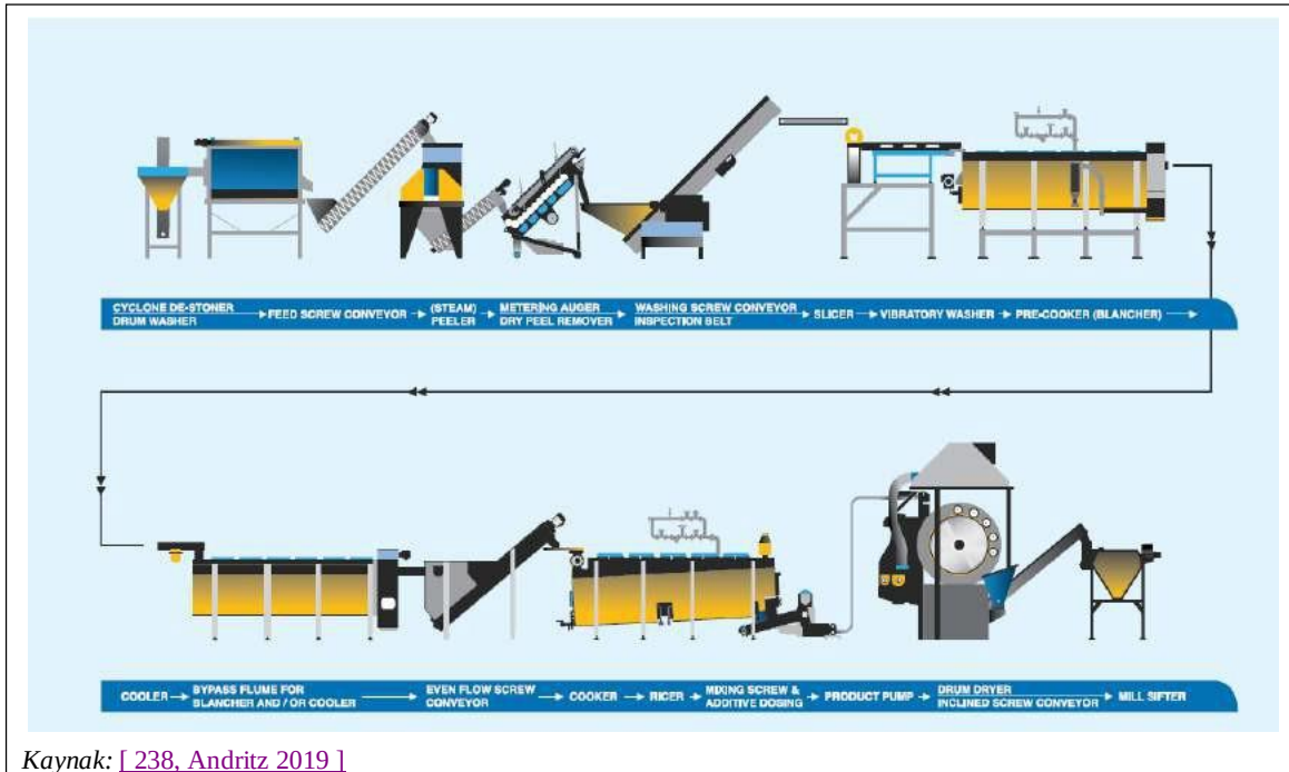
Şekil 8.1: Örnek bir patates işleme tesisindeki buharlı soyma işlemi
