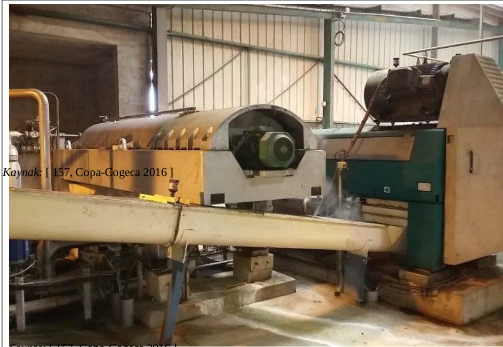
Şekil 3.10: Bir dehidrasyon sahasındaki santrifüj sistemi
