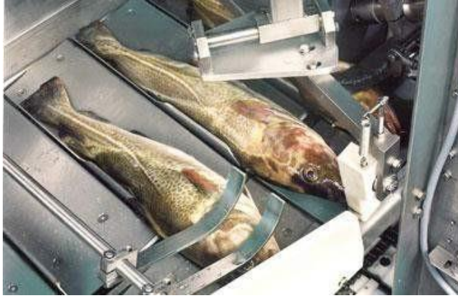
Şekil 7.5 Baş çıkarma, iç organları çıkarma ve balık yumurtası geri kazanım makinesi
