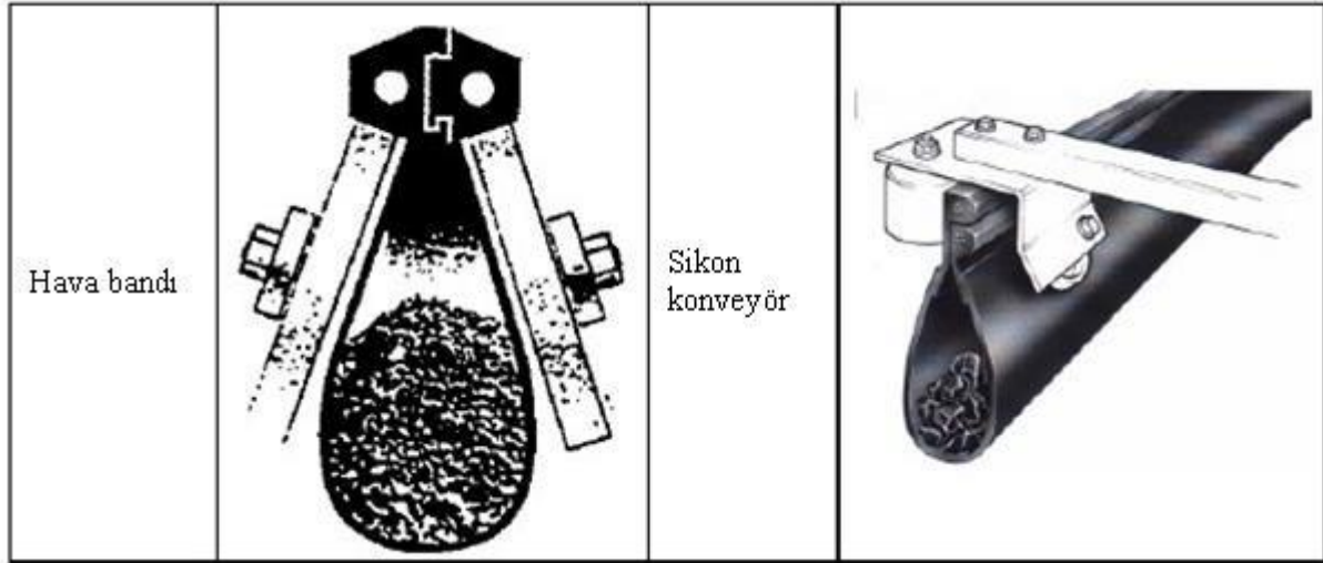
Şekil 3.44: Asılı kayış konveyörlere örnekler [78, DCMR Milieudienst Rijnmond, 1995]
