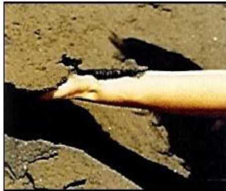
Şekil 4.19: Bir depolama yığınının yüzeyindeki kabuk oluşumu [134, Corus, 1995]
