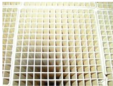
Şekil 1.67: SCR tekniğinde kullanılan katalizör örneği
