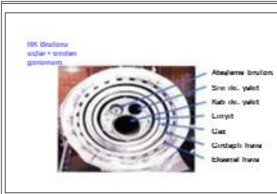
Şekil 2.14: Döner fırında (RK) kullanılan bir çok kanallı brülörün önden görünümü
