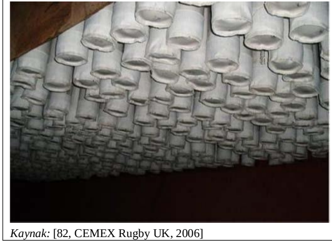
Şekil 1.60: İngiltere'de bir çimento tesisinde kullanılan torba filtre ve filtre malzemesi örneği
