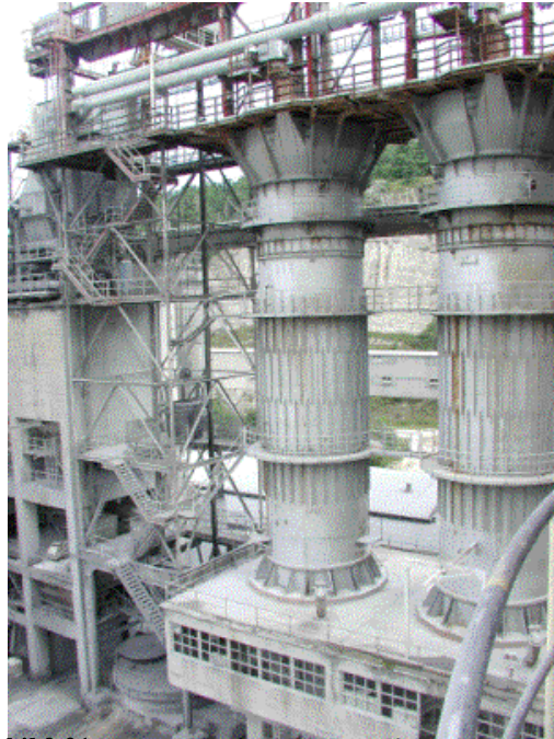
Şekil 2.21: Karışık beslemeli şaft fırının bir örneği
