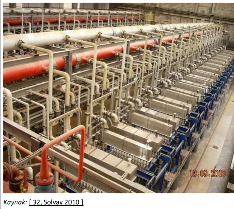
Şekil 2.11: Tek kutuplu elektrolizörlerle donatılmış bir membran hücresi odasının görünümü
