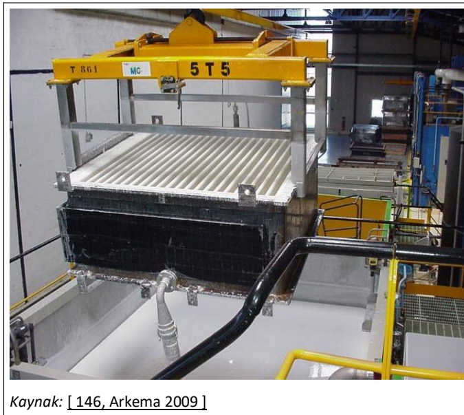
Şekil 4.2: Bir katot üzerine yerleştirilen asbestsiz bir diyaframın görünümü
