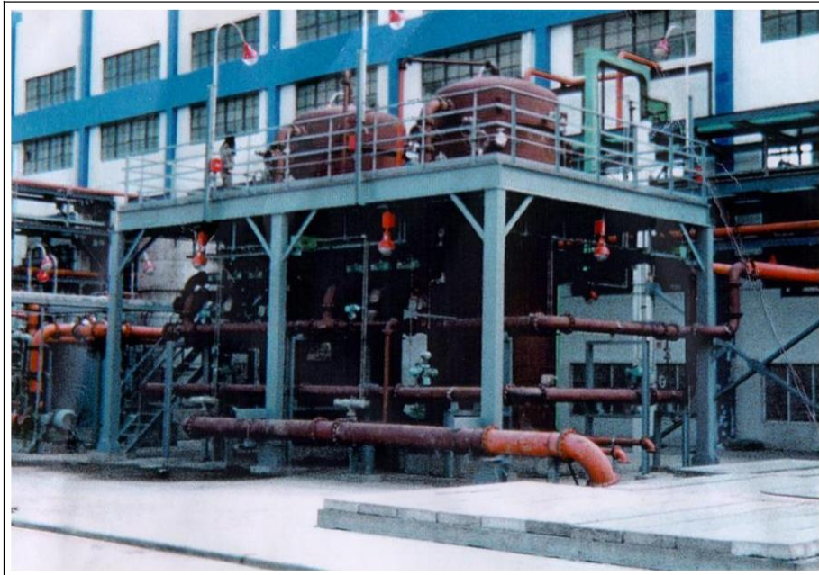
Şekil 2.16: İkincil tuzlu su saflaştırma sistemindeki parlatma filtrelerinin görünümü
