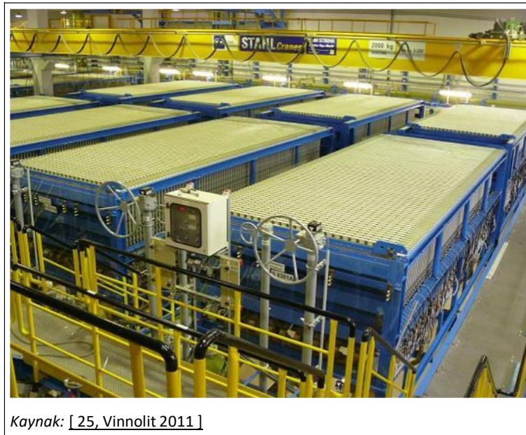
Şekil 2.10: Çift kutuplu elektrolizörlerle donatılmış bir membran hücresi odasının görünümü
