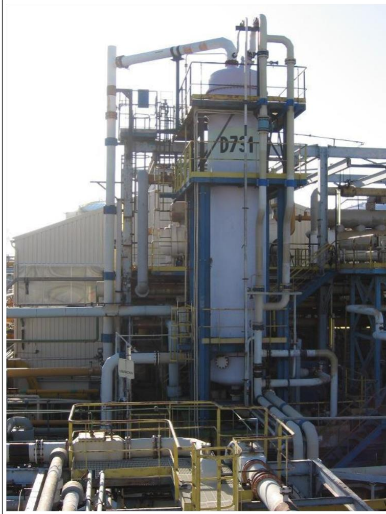
Şekil 2.18: Bir klor soğurma ünitesinin görünümü
