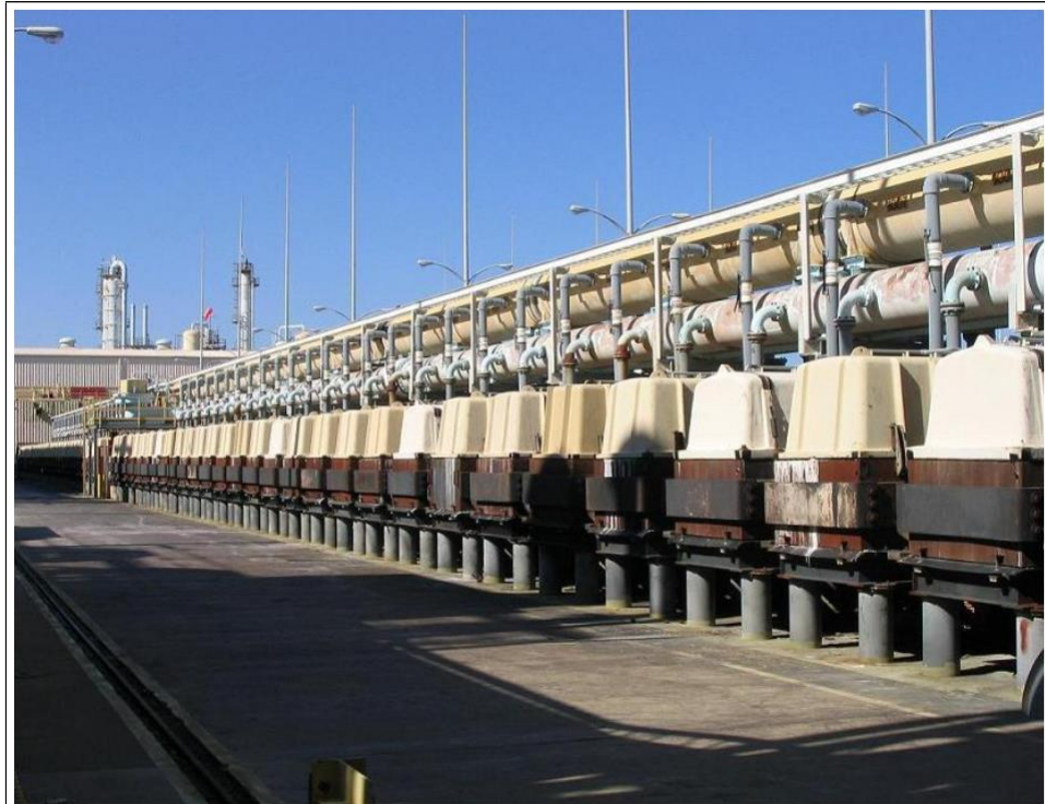
Şekil 2.7: Tek kutuplu elektrolizörlerle donatılmış bir açık hava diyafram hücresi odasının görünümü
