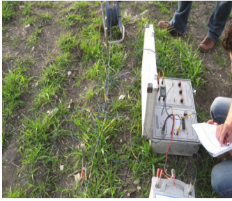
Elektrik Yöntemi ile yapılan jeofizik çalışmaları
