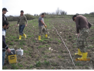
MASW (Çok Kanallı Yüzeysel Dalgası Analizi) Yöntemi ile yapılan jeofizik çalışmalar
