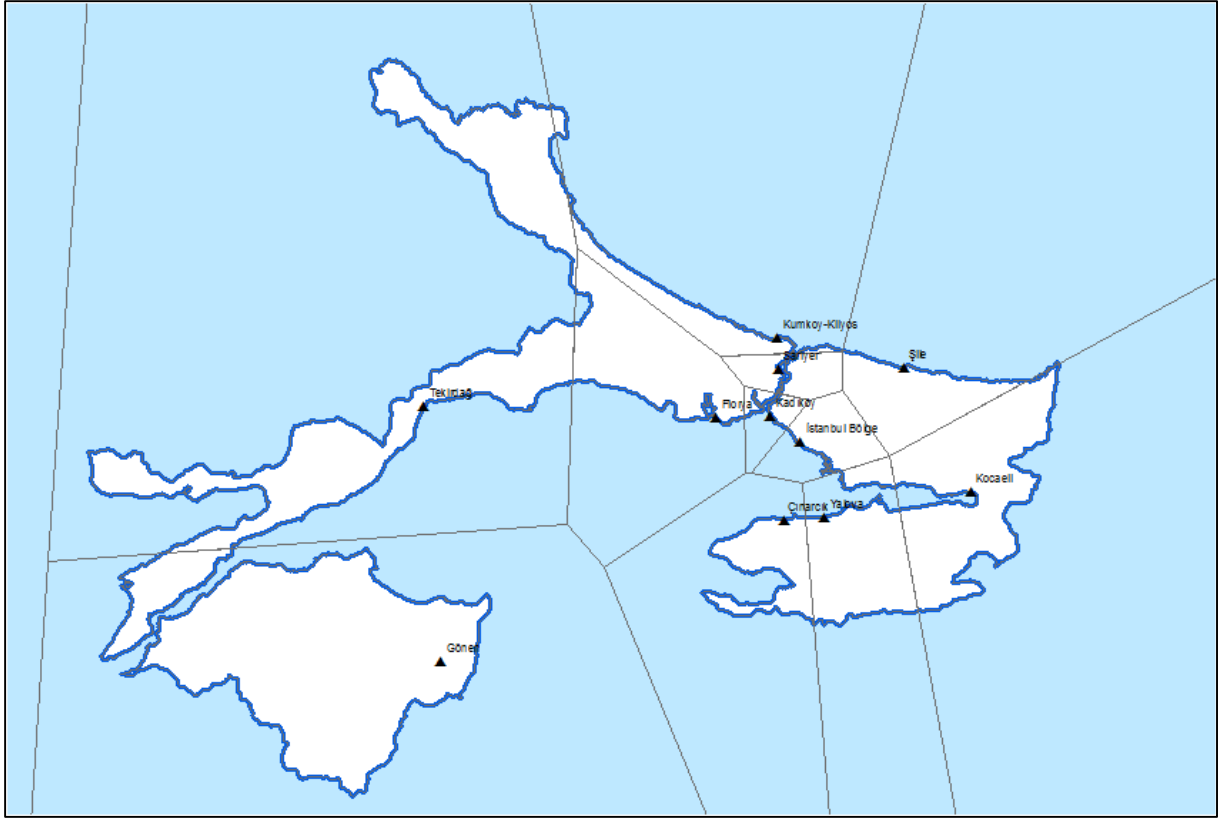
Şekil 8 Marmara Havzasında Kullanılan Meteoroloji İstasyonları ve Thiessen Poligonu
