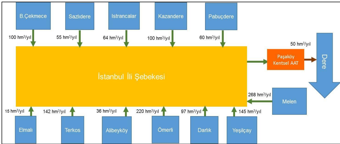
Şekil 2.5. İstanbul İli Su Transferleri Şematik Gösterimi (SYGM, 2016)
