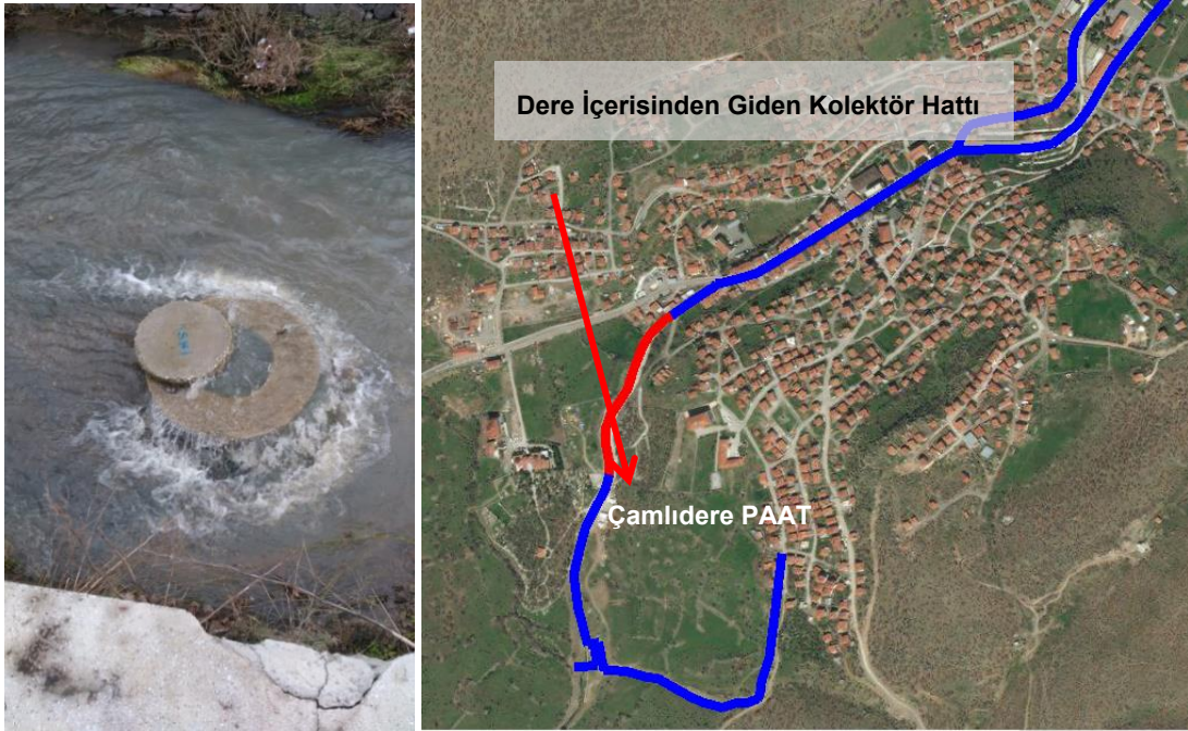
Şekil 3.33: Çamlıdere İlçesi Dere İçerisinden Giden Atıksu Hatları
