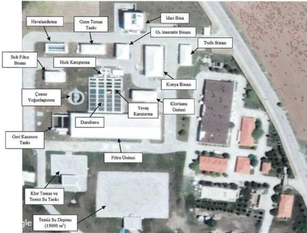
Şekil 3.29: Çubuk İAT Genel Yerleşim Planı
