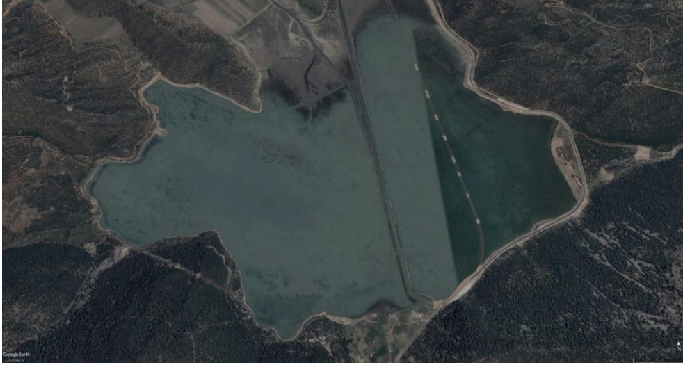
Şekil 49. Avlan Gölünde Giriş ve Çıkıřların Kanal Haline Getirilmesinden ve Kıyı Yapılarından Kaynaklanan Baskılar, Batı Akdeniz Havzası
