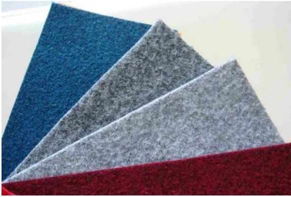
İğneleme ile sabitlenmiş Dokusuz Yüzey
