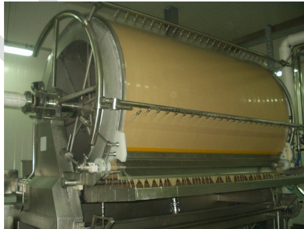
Şekil 4. Yıkama işleminde kullanılan döner filtre
