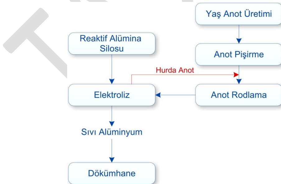
Şekil 2. Ham (sıvı) alüminyum üretimi akış şeması
