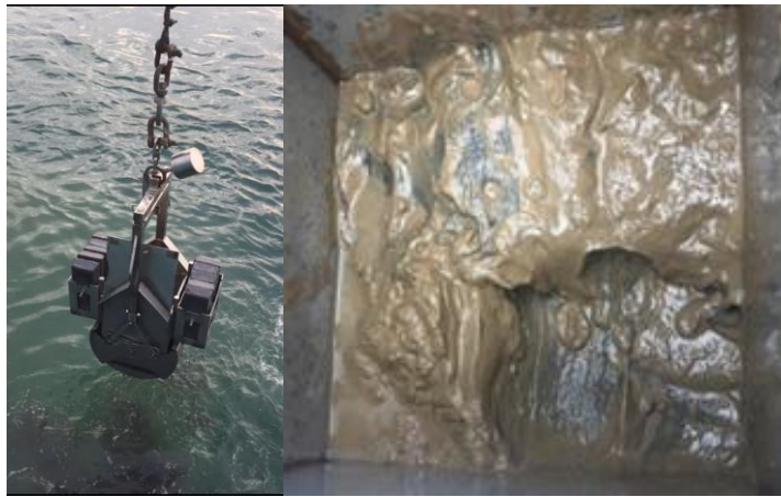
Fotoğraf-16. Boxcore ile sedimandan mikropastik örnekleme
