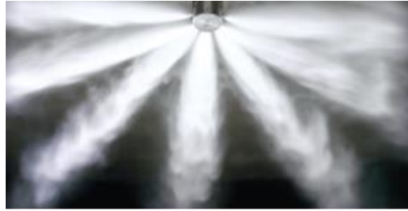
Şekil 5. Novec 1230'nin sistemden çıkışı
