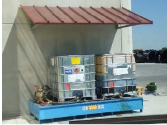
Şekil 6: Sikloentan içeren önceden karıştırılmış poliöl ve IBC tankları
