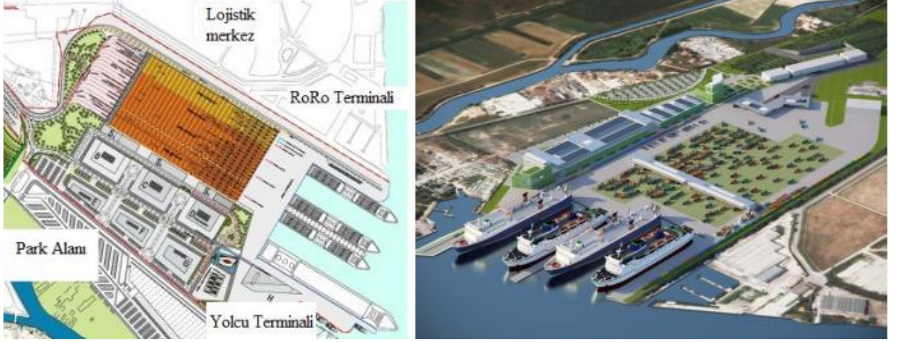
Şekil 141. Örnek Ro-Ro terminali ve kapak atmış Ro-Ro gemisi
