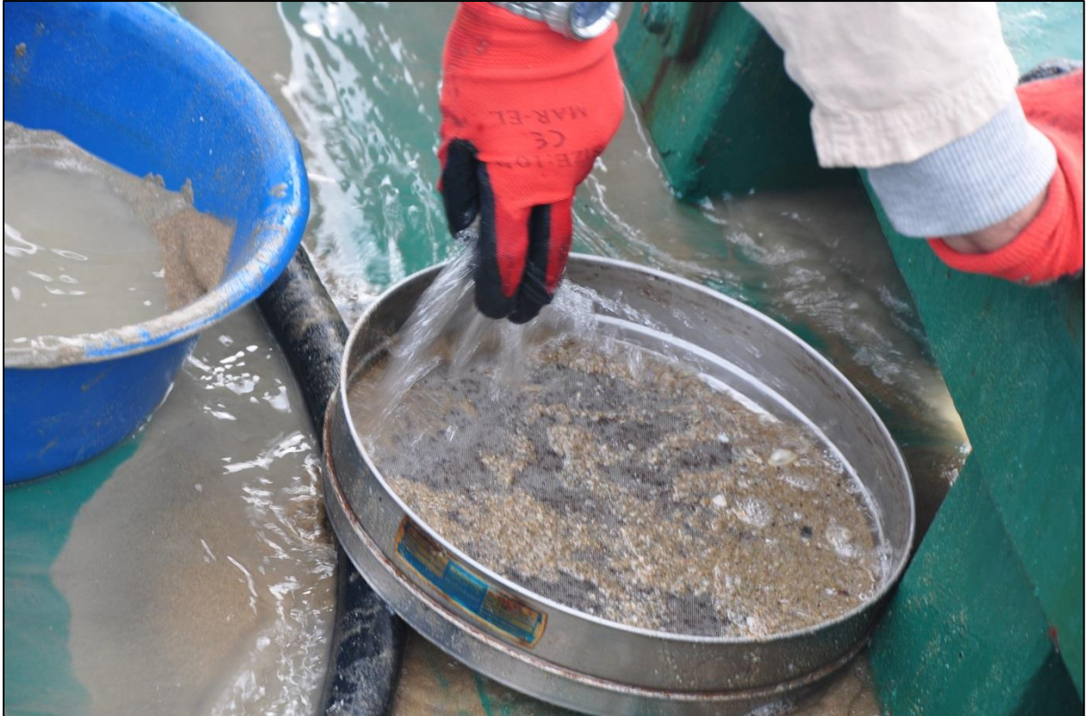
Fotoğraf 4. Bentik Organizmalar Arazi Çalışmaları (Van Venn Grap Örnekleme Sonucu Elde Edilen Örneklerin Eleklerden Süzülmesi)
