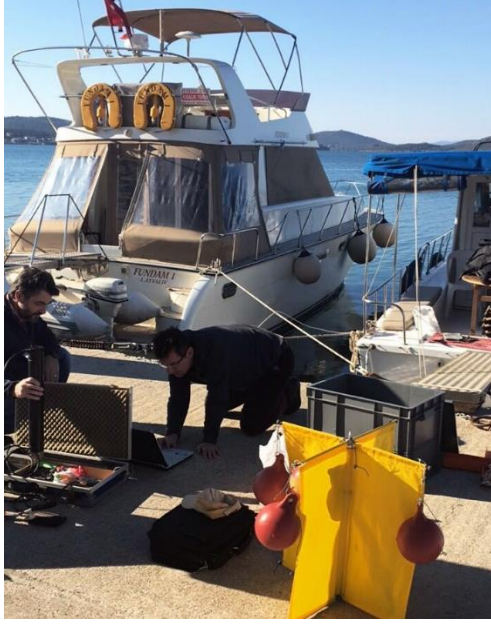
Fotoğraf 4. Nortek Aqua Doppler akıntı ölçerin kalibrasyonu
