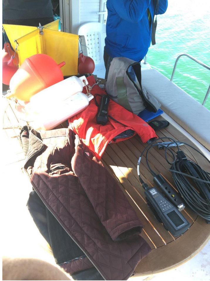
Fotoğraf 1. Ölçümleme çalışmalarında akıntı ile aynı anda sürüklenen Davies yüzeği ve Nortek Aqua Doppler akıntı ölçer
