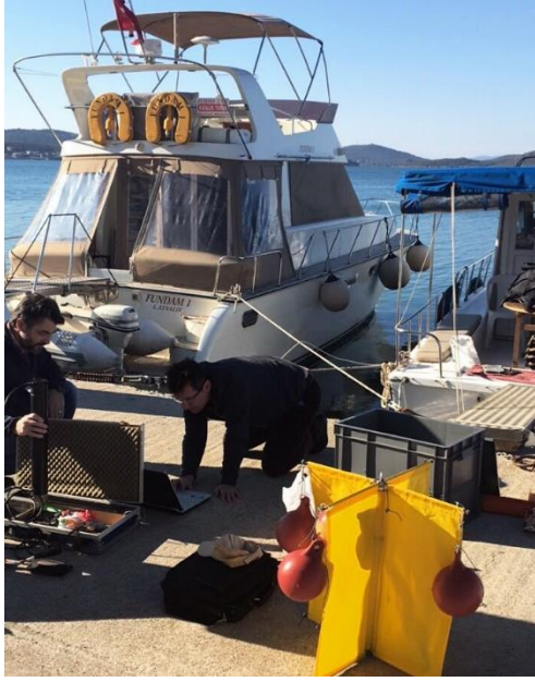
Fotoğraf 4. Nortek Aqua Doppler akıntı ölçerin kalibrasyonu
