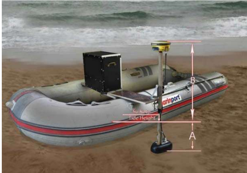
Fotoğraf 2. Bot üzerinde bulunan GPS anteninin su seviyesi ve echosounder transducerine olan ofsetleri dengeli yük dağılımı
