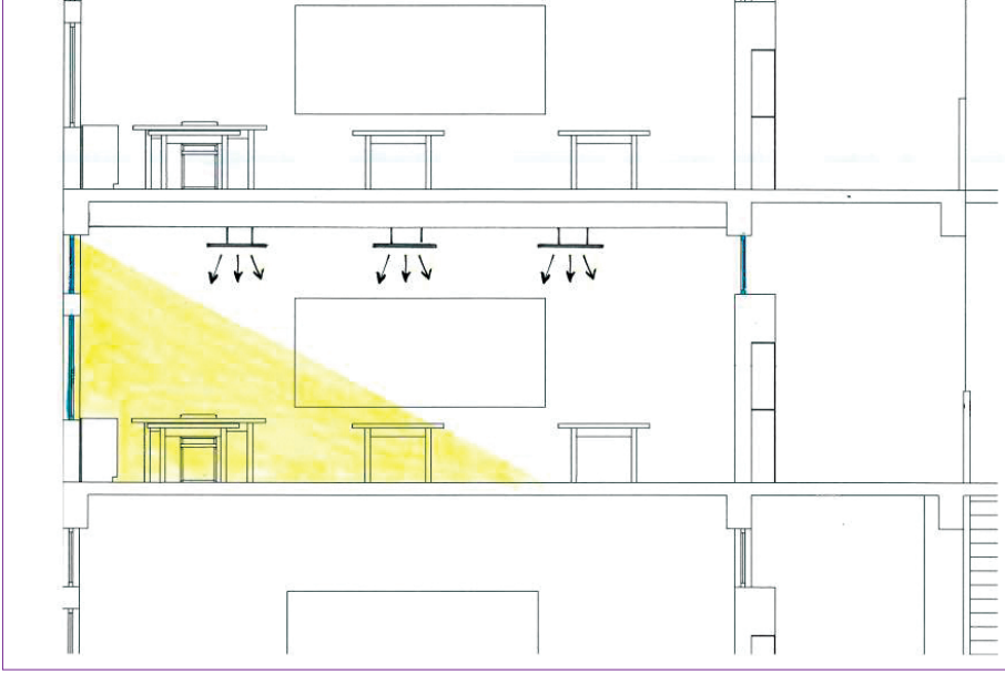
Şekil 24. Derslik Aydınlatma prensibi
