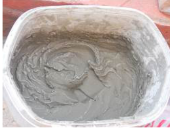
Şekil 12. Harç karışımının uzun süre açık havada bekletilmesi
