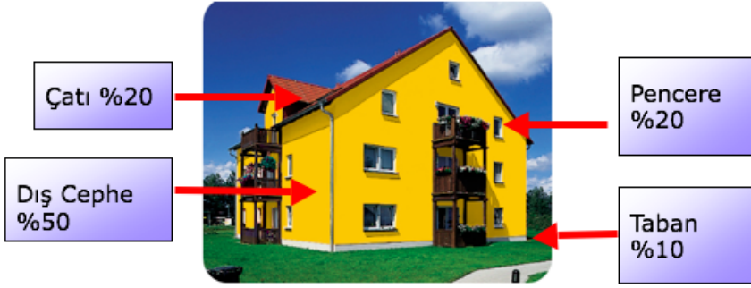
Şekil 4. Binalarda ısı kayıp oranları
