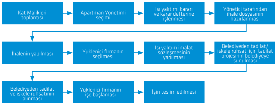
Şekil 5. Isı yalıtımı iş akış şeması
