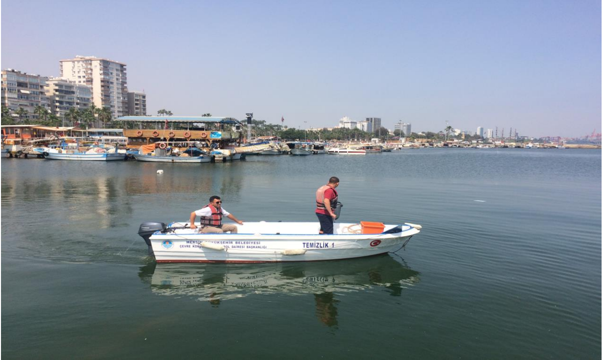
Şekil 55: Mersin Büyükşehir Belediyesine ait Deniz Yüzeyi Temizleme Aracı(Fiber Temizlik Teknesi)
