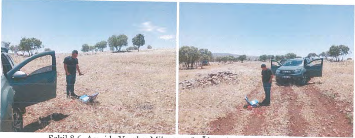
Şekil 8.6. Arazide Yapılan Mikrotremör Ölçümlerine Ait Görüntüler
