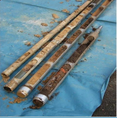
Pencereli örnekleyici boruları - Çapı derinlikle azaltma
