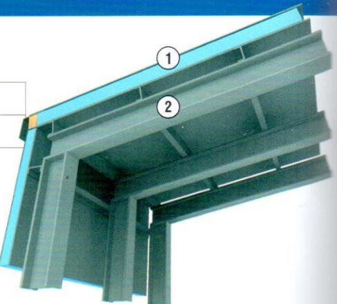
Resim 30- Hafif metal çatılarda ısı yalıtımları detayı
