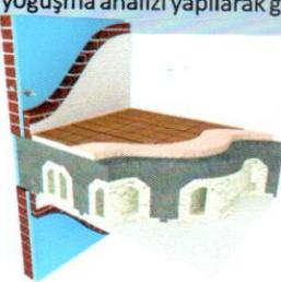
Resim 20a - Dolgu duvar ısı yalıtım detayı
