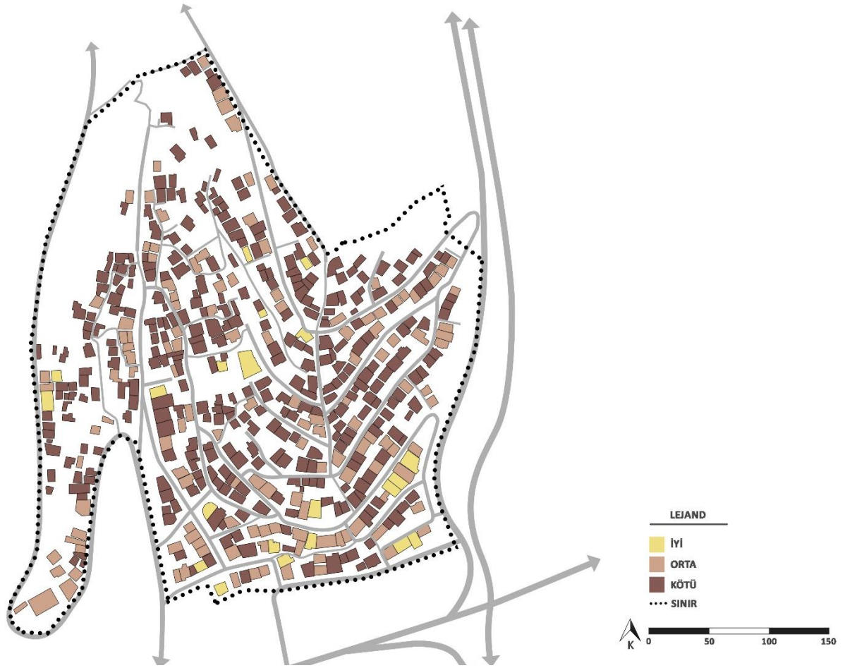
Şekil 31 Bina Durumu Analizi (Kaynak: Cedit Riskli Alanı Mevcut Durum Analizi Araştırma Raporu, 2016)
