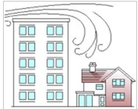
Şekil 6.1. Yüksek Engellerin Baca Üzerine Etkisi
