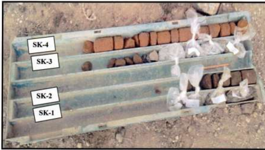
RESİM-3 : S.K.-1,2,3,4'den alınan zemin örneklerinden görünüm
