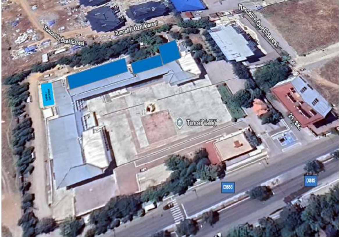
Şekil 11 Tunceli Hükümet Konağı Çatı PV Yerleşimi
