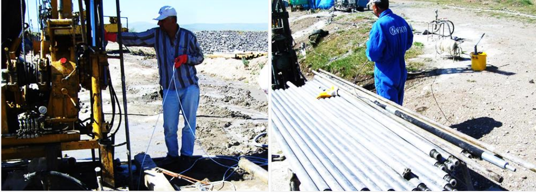
Fotoğraf 4: BASINÇLI SU DENEYİ ÖRNEK GÖRSEL
