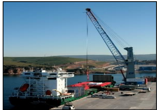
Şekil 27. MHC (Mobile Harbour Crane)
